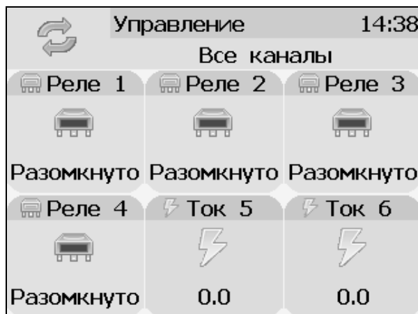
Рисунок 6.10 Вид экрана состояния каналов управления
