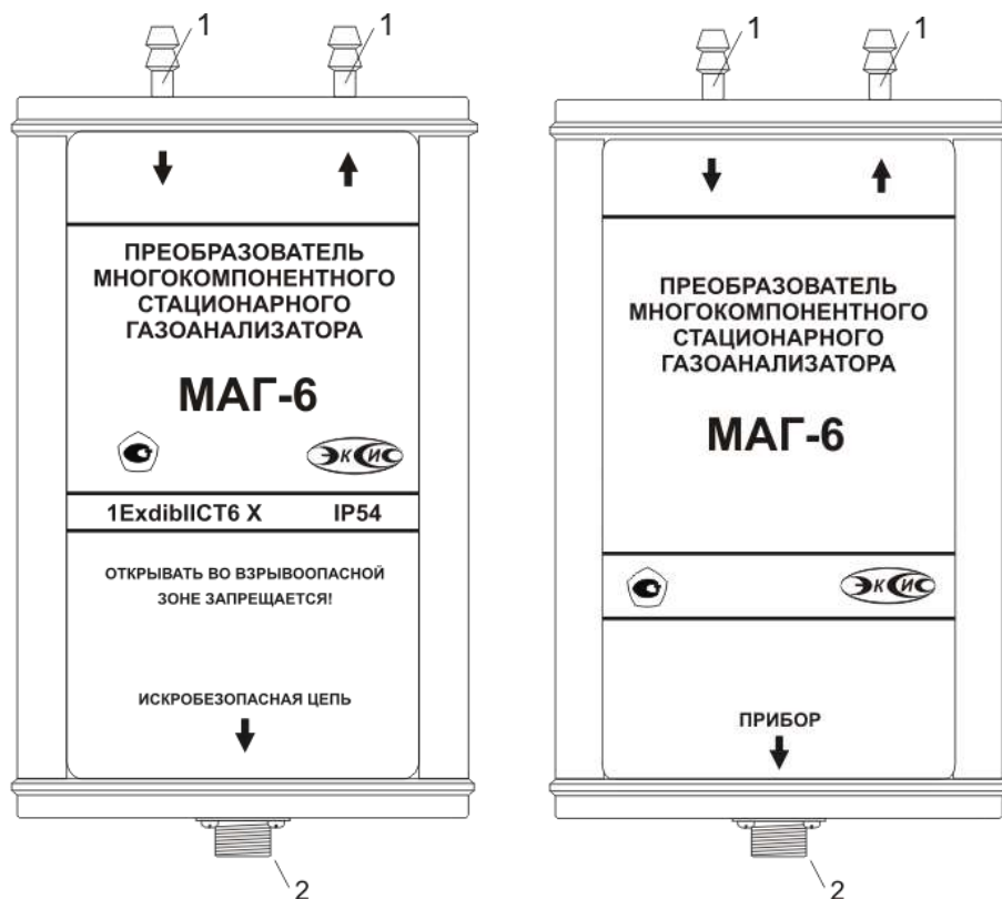
Рисунок 3.18 Измерительный преобразователь МАГ-6 слева на право: взрывозащищенного исполнения, стандартного исполнения 1 – газовые штуцера («вход» и «выход» соответственно); 2 – разъем для подключения к прибору
